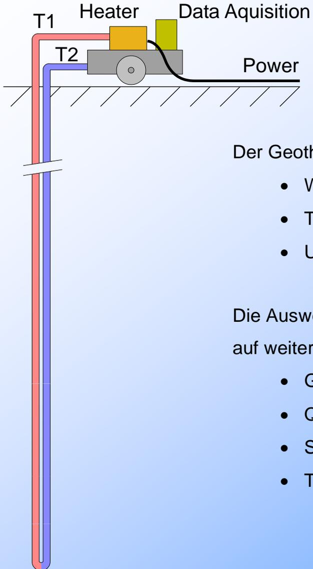
Der Geothermal-Response-Test dient in erster Linie zur Bestimmung von
