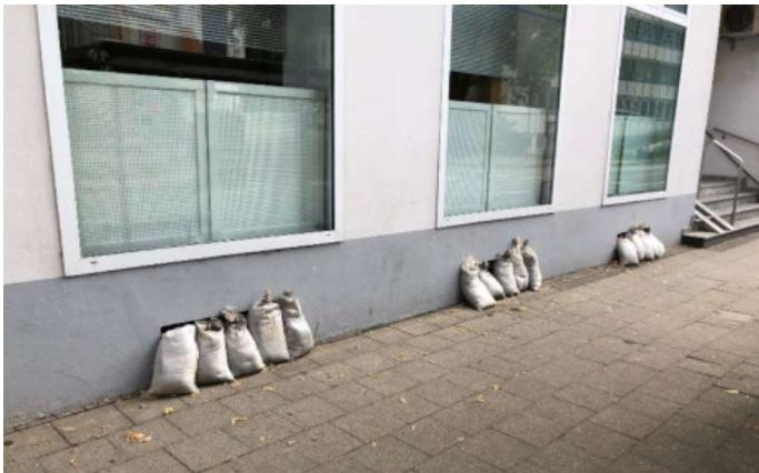
In Bereichen mit einem hohen Wasseranfall bei Stark- oder Extremniederschlägen und/oder bei Flusshochwasser, die keine ausreichenden Flächen zur Versickerung oder Zwischenspeicherung von Wasser zur Verfügung stellen können, sind alle Maßnahmen des Objektschutzes eine sinnvolle Alternative.
